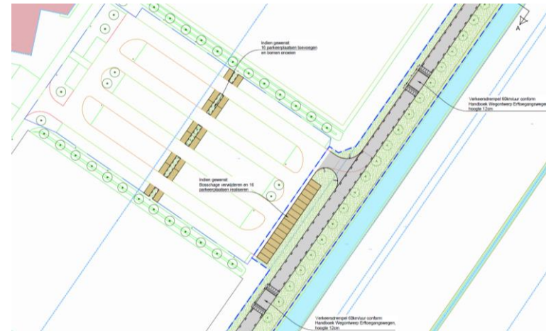
Figuur 2.6: Uitritconstructie parkeerterrein en locatie voor realiseren van 32 extra parkeerplaatsen voor SV Poortugaal
