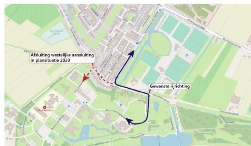
Figuur 3.2 - Afsluiting westelijke aansluiting Antesterrein in de plansituatie 2030
